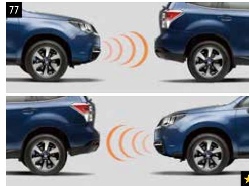
**77** Ultraschall Einparkhilfen für vorne und hinten
